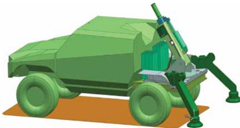
■ 120 mm vedený mínomet so zabudovanými hydraulickými podperami a spevneným rámom
