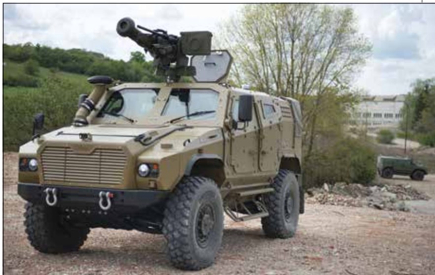
■ Na strechu vozidla je možné osadiť prakticky akýkoľvek zbraňový systém do hmotnosti 500 kg
