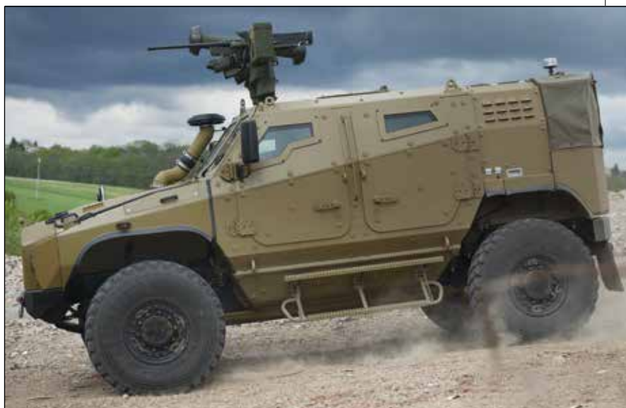
■ Špeciálny podvozok, masívny krútiaci moment a svetlá výška až 465 mm zaisťujú vozidlu excelentnosť v teréne
