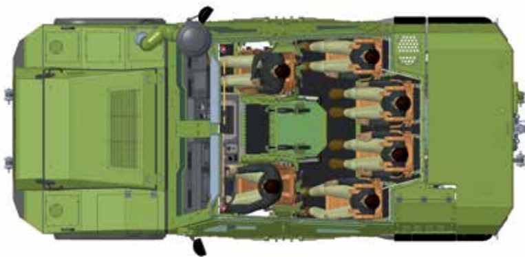
■ Schéma rozmiestnenia 6-člennej posádky v bezpečnostnej kapsule vozidla Gerlach
