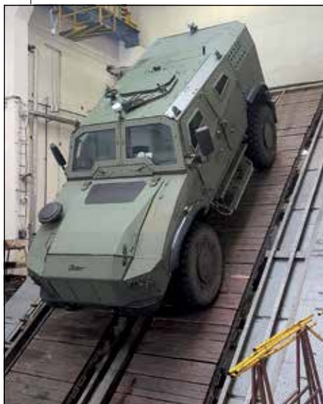
■ Testovanie účinnosti parkovacieho brzdného systému vozidla Gerlach, na snímke dosiahnutý sklon 83,9 %
